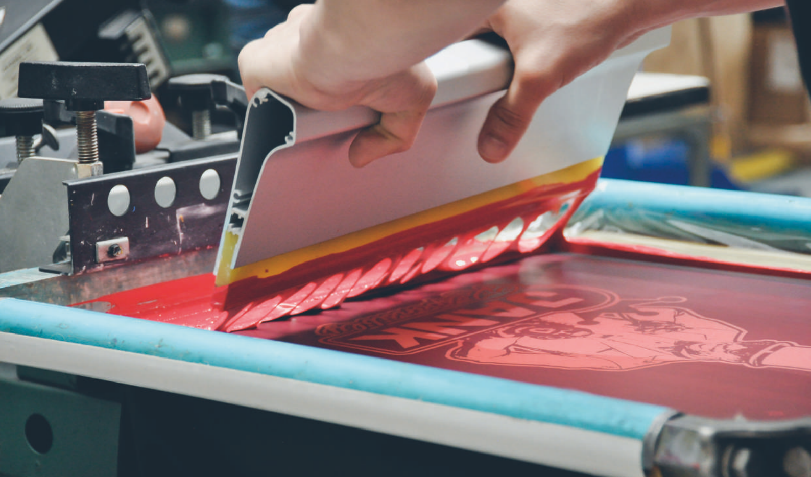
Aplicación de la tinta sobre la pantalla en el proceso de serigrafía.
