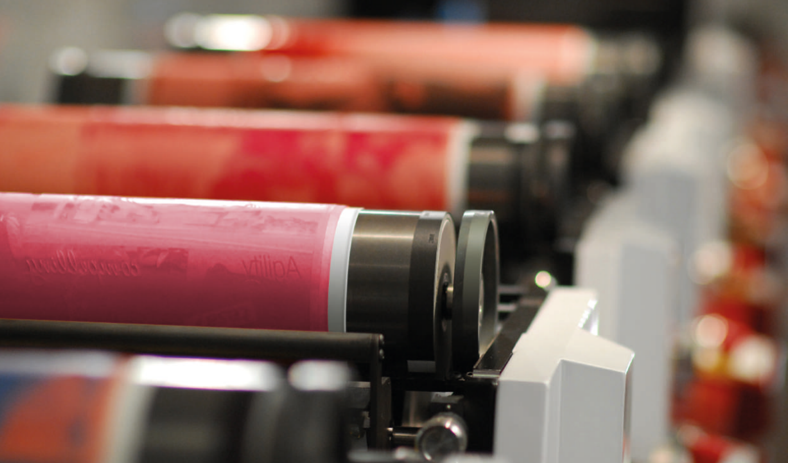
Detalle de los rodillos de una máquina de flexografía.
