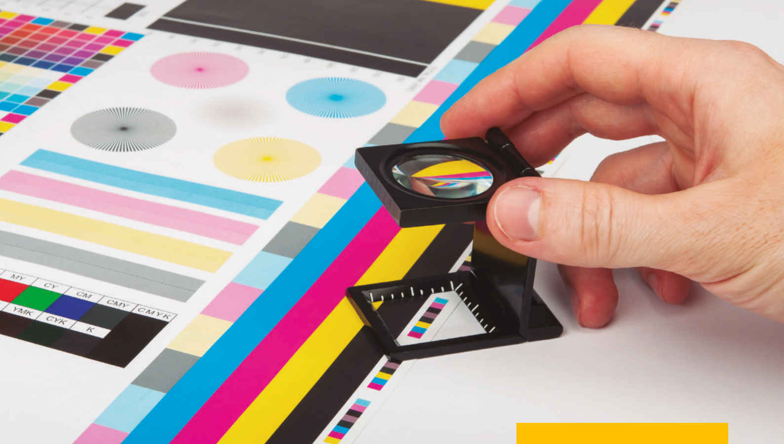
Observación (mediante un busca hilos) de la trama en la tira de control
