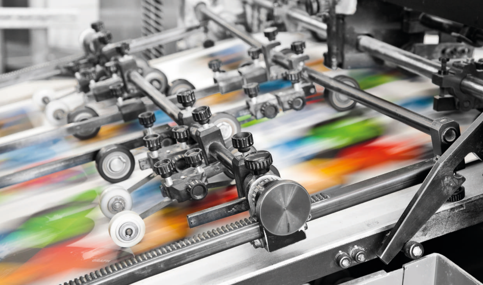
Rodillos en funcionamiento en una rotativa.
