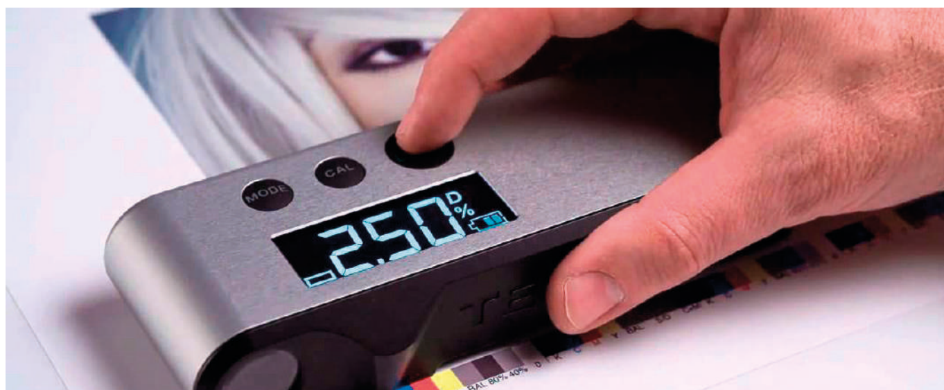
Pruebas densitométricas del proceso de gestión de color.
