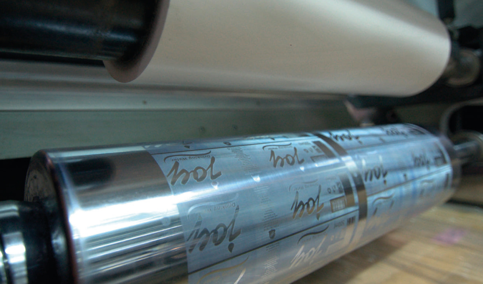
Preparación de la forma impresora (cilindro) para huecograbado.
